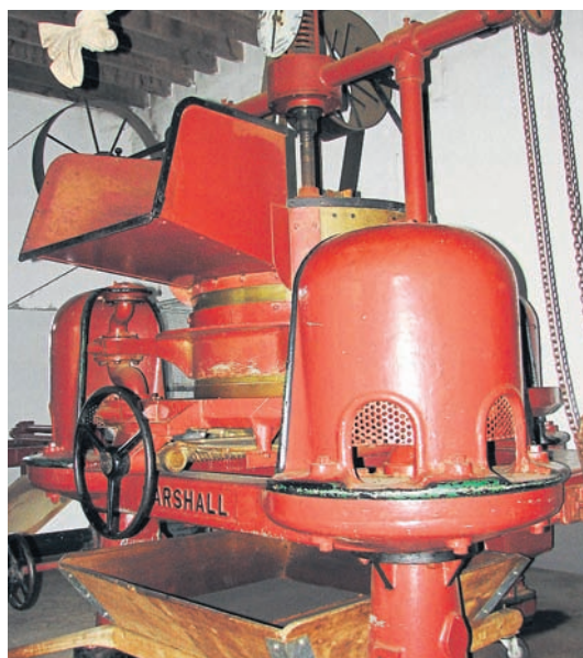
Alt, aber noch vollkommen funktionsfähig: die Maschine, in der die welken Blätter gerollt werden.
