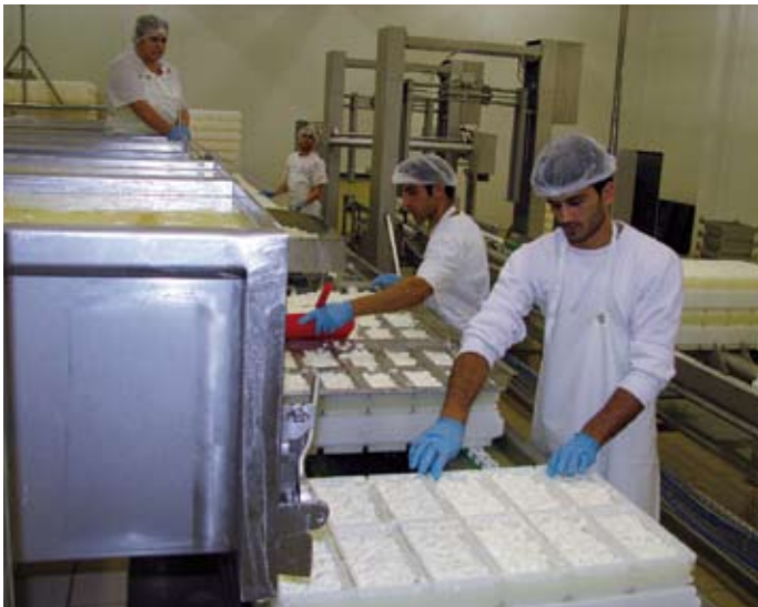
Ist der Käsebruch fest genug, wird am Becken die Schleuse geöffnet, damit er in die Formen gefüllt werden kann
