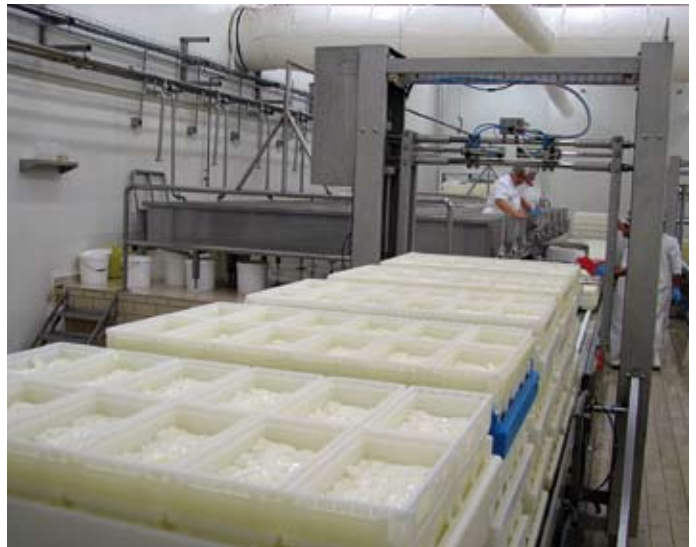
Die Paletten bewegen sich automatisch auf dem Förderband weiter in Richtung Presse
